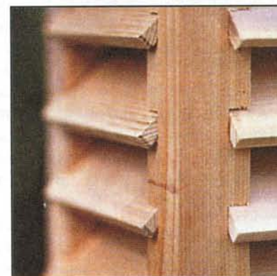
Жалюзи вставляют в пазы на боковых сторонах угловых стоек.
