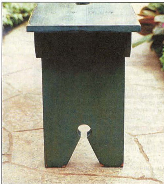
Прочная установка. Для обеспечения дополнительной опоры фартуков в верхней части ножек по бокам вырезают заплечики. Фартуки крепят ещё и к сиденью. Для большей прочности в каждую ножку вворачивают по четыре шурупа.
